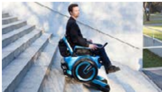
Figura 3. Mecanismo híbrido ruedas-oruga.
