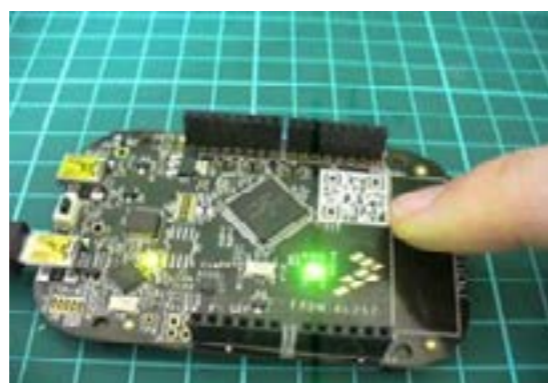
Figura 9. Sistema de control mediante sensor táctil.
