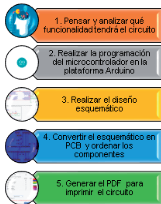
Figura 1. Diagrama de flujo del diseño de la tarjeta electrónica impresa
